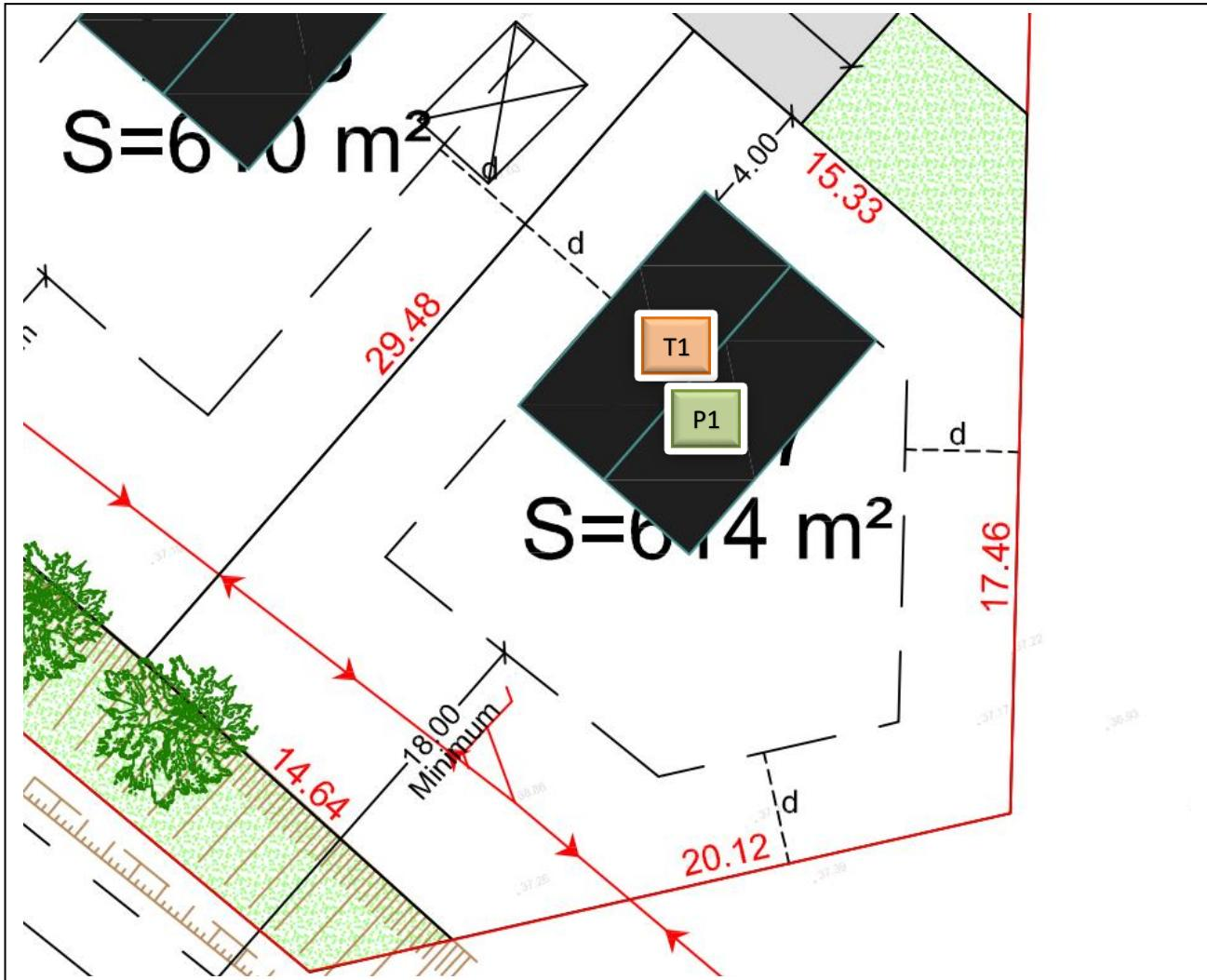
Sondage pénétromètre dynamique : P1
