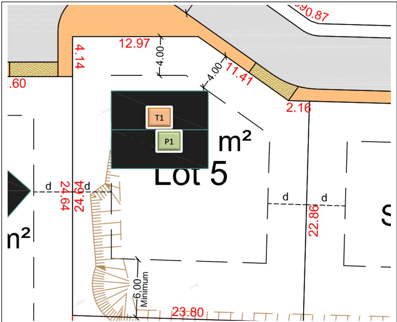
Sondage pénétromètre dynamique : P1
